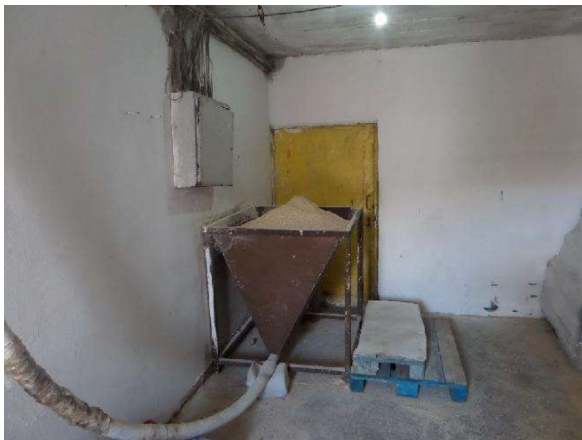
Slika 12. Koš iz kojeg se vrši automatski dotok hrane
