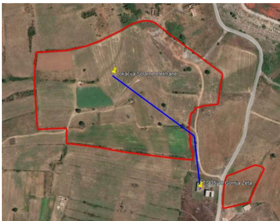
Slika 19. Predviđeni način priključenja SE na TS 35/10 kV Gornja Zeta preko 35 kV kabla
